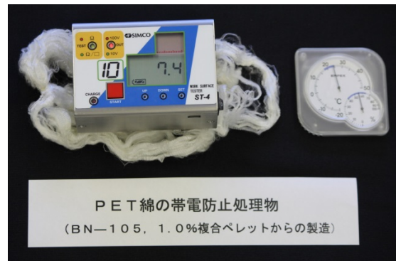
写真②、BN-105を1.0%添加した加工用ペレットで製造した綿状不織製品
