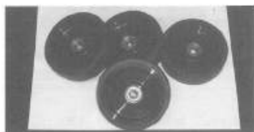
写真3 常時床面と接触、摩擦しているため帯電荷が蓄積しやすいキャストロール (BN-01AMで無帯電化に成功)
