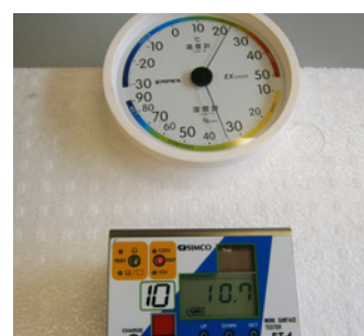
「BN-105」添加品を重ねて接触させると、内面の静電気が消滅するため樹脂粒が付着せず袋内で移動しやすい
