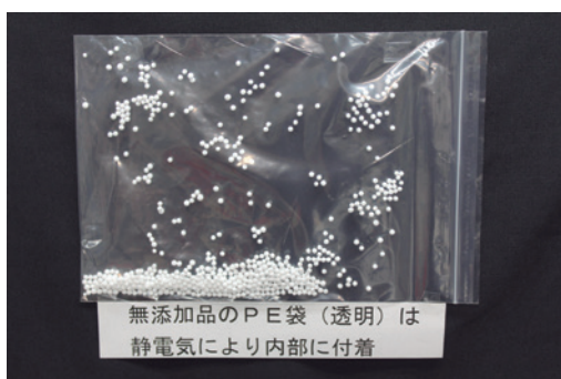
無添加フィルムは静電気が発生し内面の各所に付着する様子が分かる
