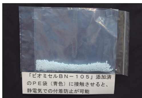
「BN-105」添加品を重ねて接触させると、内面の静電気が消滅するため樹脂粒が付着せず袋内で移動しやすい
