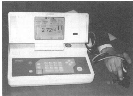
写真5 PP射出成形試料の電気特性改質実態を表面抵抗値の低下を見て調べている
