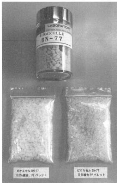
写真4 「バイオミセル BN-77」製品と樹脂へ複合させたペレット
