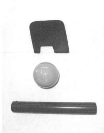
写真7 〈ビオミセル BN-77〉を均質複合して、半導体域へ電気特性を変化させたABS樹脂真球（中央）（下：PP被覆製品、上：PP射出成形品）
