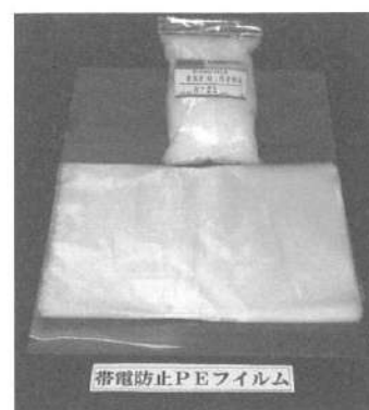
写真6 〈バイオミセル BN-77〉を複合している帯電防止PEフィルム
