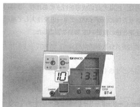
写真3 高分子型帯電防止剤を共存させている発泡 PP 製品の表面抵抗率測定結果
