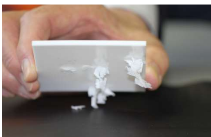
写真① 無添加品 帯電するポリ 4 フッ化エチレン (P T F E) 帯電する状態
